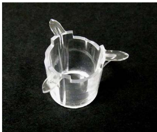
図2 コラーゲンビトリゲル®膜チャンバー （筒状の枠の底面にコラーゲンビトリゲル®膜がはられている）
