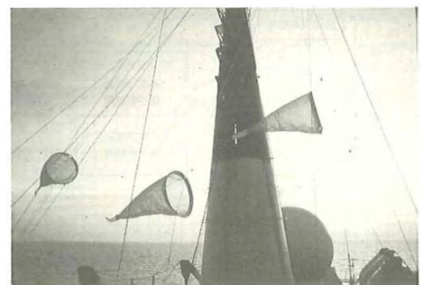
図 1 東シナ海洋上の気象観測船上でのネットトラップによるイネウンカ類の移動調査
