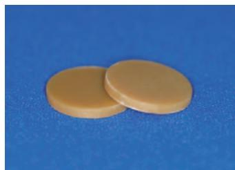
フィブロイン製の基板
